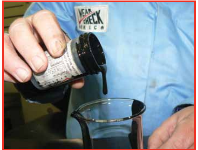
Un échantillon d'huile moteur présentant une viscosité très élevée en raison d'une surchauffe
