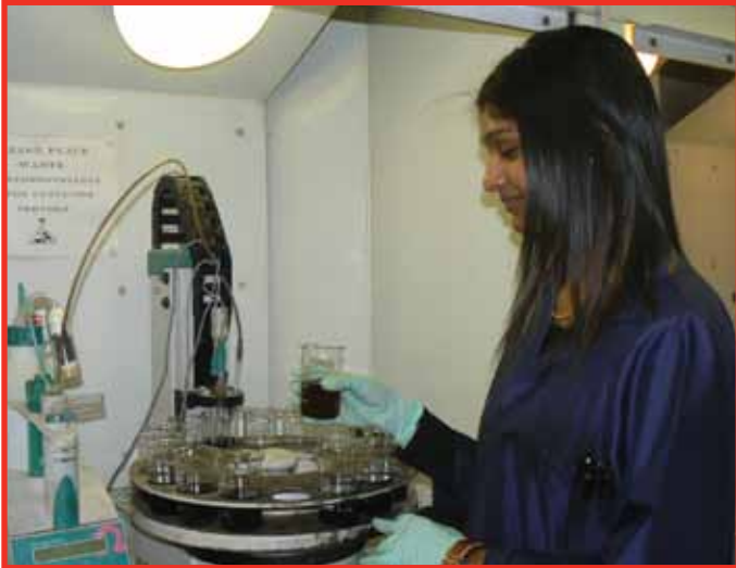
Technicienne testant les additifs de neutralisation dans des échantillons d'huile
