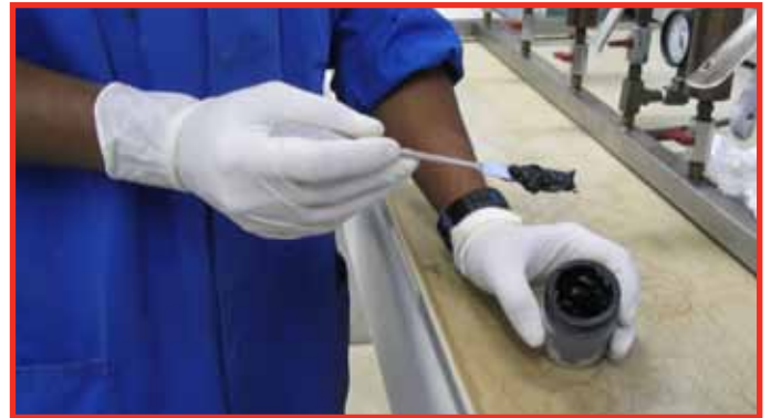
Óleo de motor com sedimentação grave (contaminação por fuligem)
